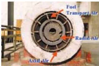
รูปที่ 1.1 หัวฉีดเชื้อเพลิงก่อนปรับปรุง (Primary Air 12%)
