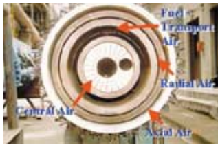
รูปที่ 1.2 แสดงหัวฉีดเชื้อเพลิงหลังการปรับปรุง (Primary Air 8.43%)
