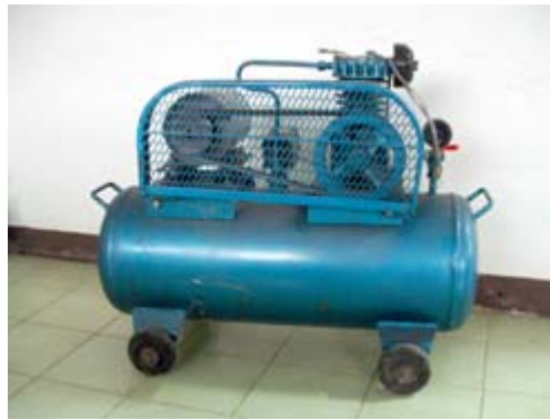
รูปที่ 8 เครื่องอัดอากาศแบบลูกสูบที่ทางโรงงานใช้งาน
