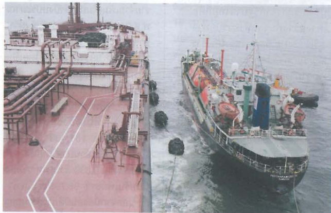
เรือแก๊สลอยน้ำ - สยามแก๊สฯ ลอยลำเรือแก๊สลอยน้ำ ไว้ที่บริเวณอ่าวอุดม จังหวัดชลบุรี เพื่อรองรับการนำเข้าแก๊ส LPG และส่งต่อผ่านเรือเล็กเพื่อกระจายแก๊สไปยังผู้บริโภค ตามนโยบายของกระทรวงพลังงานในการเปิดเสรีนำเข้าแก๊ส LPG
