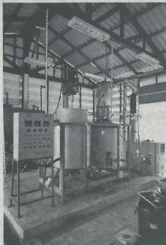
เตาปฏิกรณ์ ต้นแบบกระบวนการไพโรไลซิส
